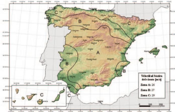
Figura D.1 Valor básico de la velocidad del viento, v<sub>b</sub>
